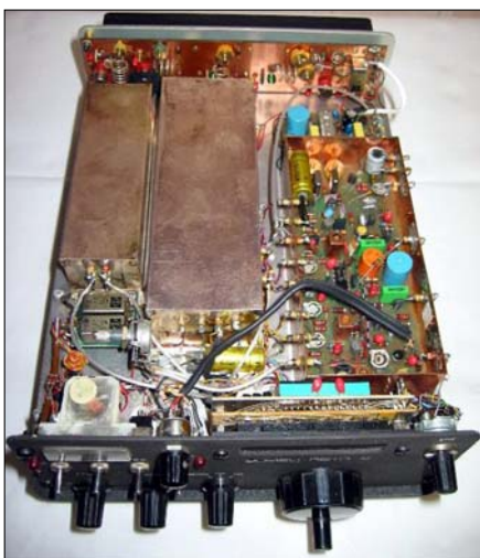
Sl. 29g. VHF transiver "Semco-rot S", pogled iznutra-odozgo
