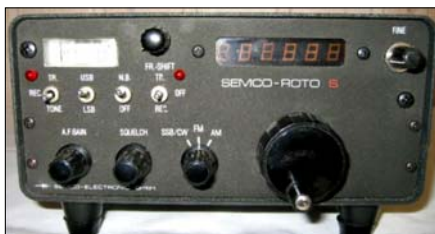
Sl. 29e. Fabrički VHF transiver "Semco-rot S" sa digitalnom skalom, iz 1977.
