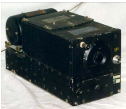
Sl. 27 Avionski prijemnik BC-454 čiji je frekventni opseg bio od 3 do 6MHz
