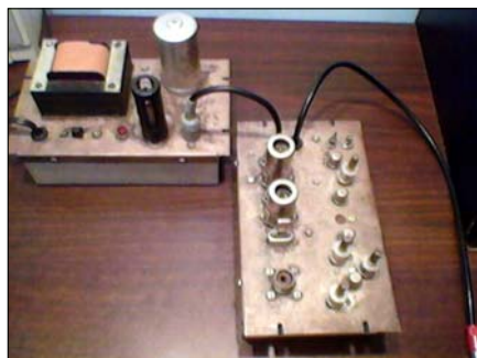
Sl. 30. Konvertor sa cevima "Nuvistor" za 2m band, koga je konstruisao i napravio Sveta YU1NRU
