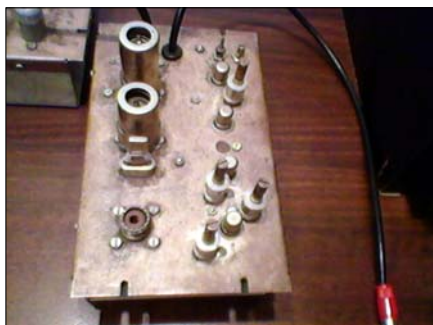
Sl. 30a. Konvertor sa nuvistor cevima, odvojen od ispravljača – pogled odozgo (konstruisao YU1NRU)
