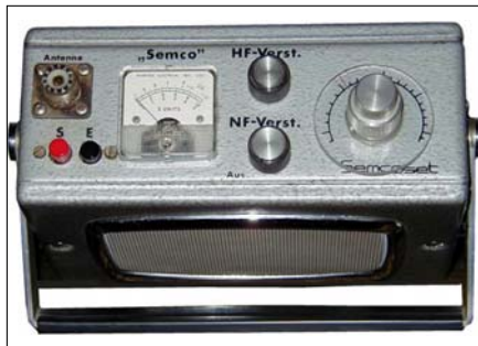
Sl. 29. VHF transiver "Semco" (AM) koga je proizvela nemačka firma "Semcoset" krajem 60-tih godina XX veka
