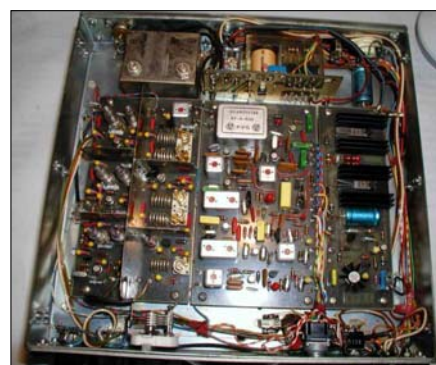
Sl. 29c. Pogled unutra fabričkog VHF uređaja "Semco-moto"
