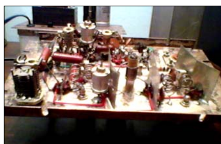
Sl. 30c. Konvertor sa nuvistorima – pogled odozdo i sa strane šasije (konstruisao YU1NRU)
