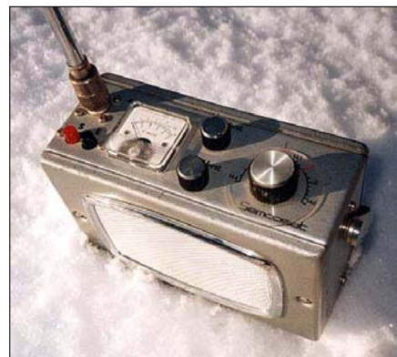
Sl. 29a. Pogled odozgo na VHF transiver (AM) "Semco"; izlazna snaga mu je bila oko 500mW
