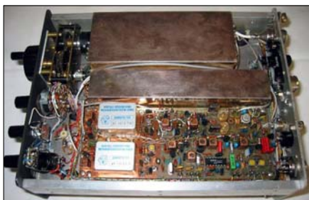
Sl. 29f. VHF transiver "Semco-rot S" pogled iznutra i sa strane
