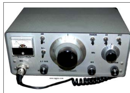
Sl. 29b. Fabrički VHF transiver "Semco-moto", koji je radio u režimu rada sa AM i SSB
